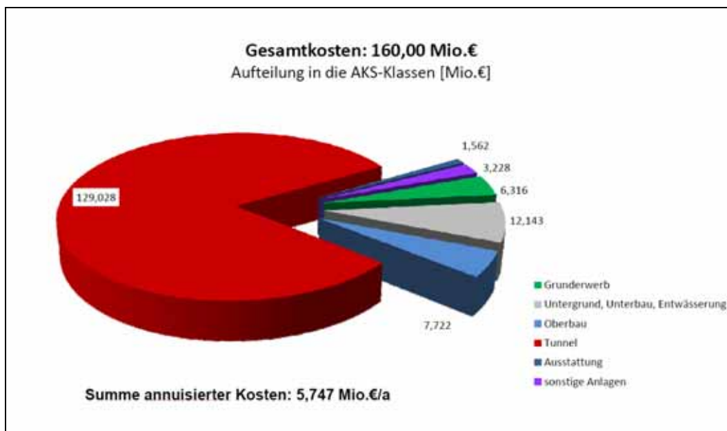
Bild 7: Kosten des Tunnelbaus gemäß Variante 3.2+E
